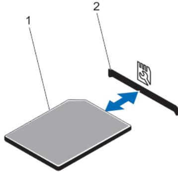
图 23: 卸下并安装 SD vFlash 卡
