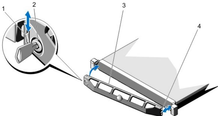
图 8: 卸下并安装前挡板
