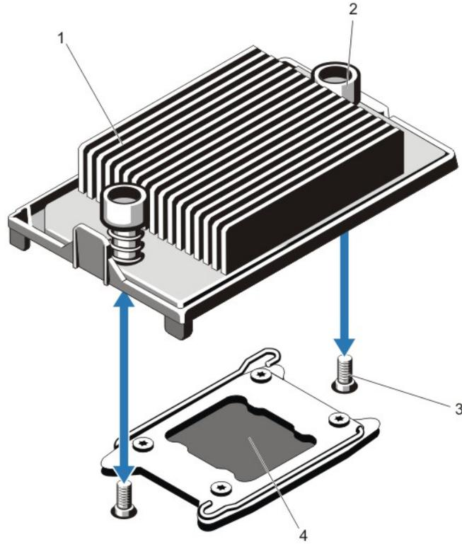
图 26: 卸下和安装散热片
