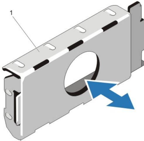
图 33: 卸下和安装电源设备挡片
