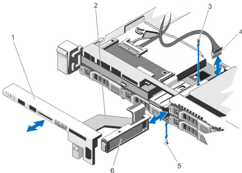
图 40: 卸下和安装 VGA 模块
