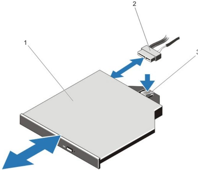
图 17: 卸下和安装光盘驱动器
