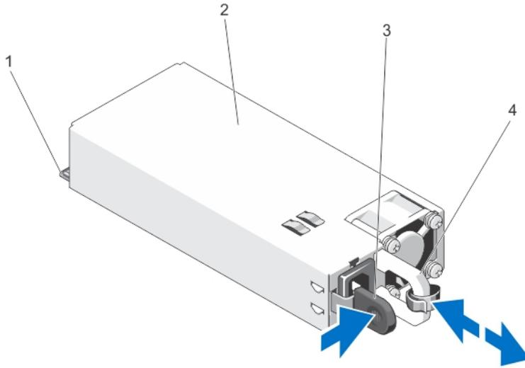
图 29: 卸下和安装交流电源设备
