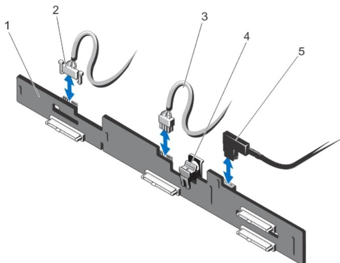
图 36: 卸下和安装 2.5 英寸（x4）硬盘驱动器背板
