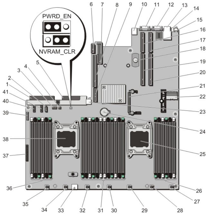
图 42: 系统板连接器和跳线
