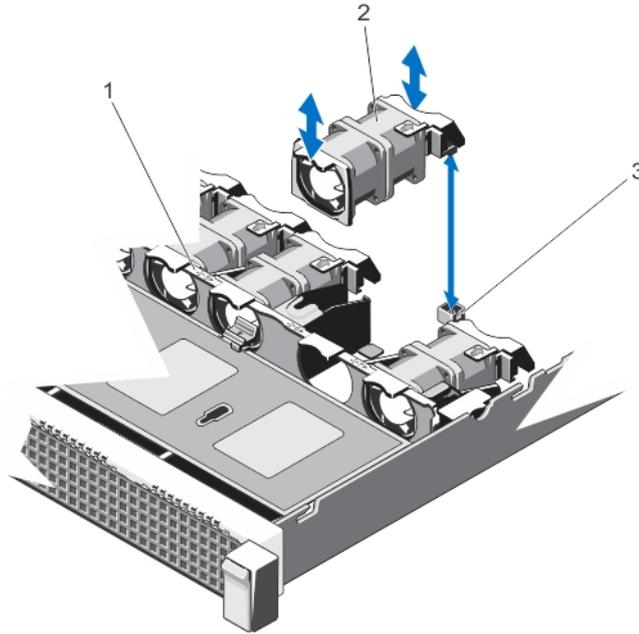
图 18: 卸下和安装冷却风扇
