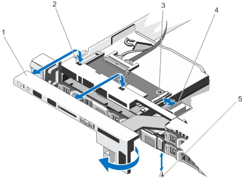
图 39: 卸下和安装控制面板
