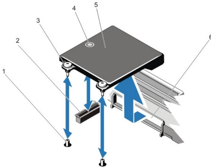
图 25: 卸下和安装网络子卡
