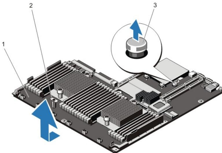
图 41: 卸下和安装系统板
