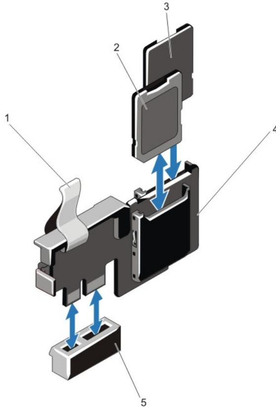
图 24: 卸下和安装内部双 SD 模块
