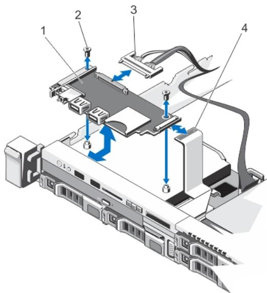
图 38: 卸下和安装控制面板线路板
