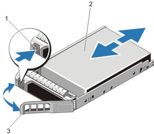
图 15: 卸下和安装热置换硬盘驱动器
