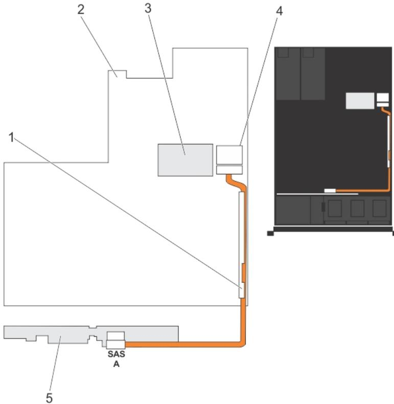
图 37: 布线图 — 2.5 英寸 (x4) 系统
