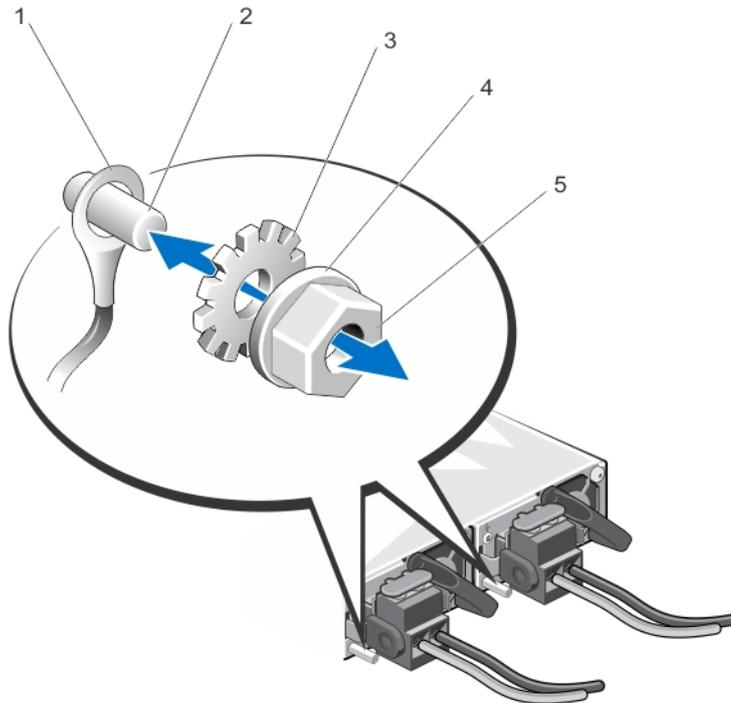
图 30: 安装和连接安全接地线
