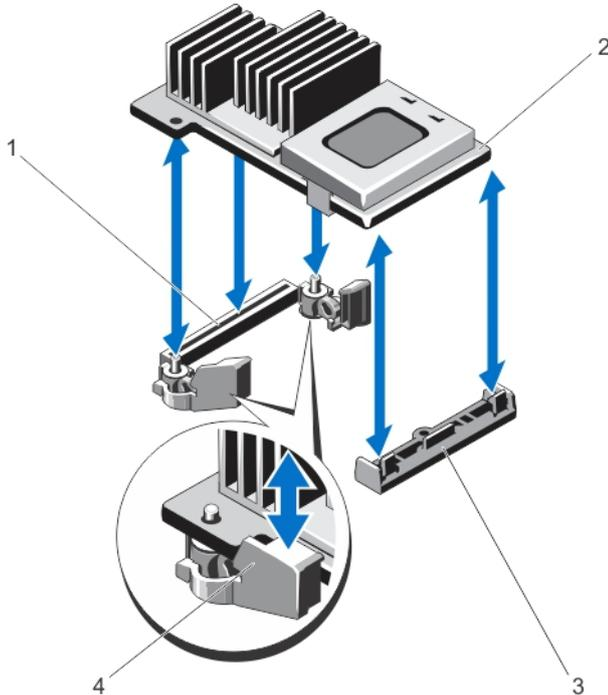
1. 系统板上的存储连接器
